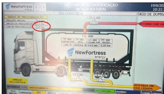
Figura 30 – Imagem do PLC de descarregamento dos isotanques
